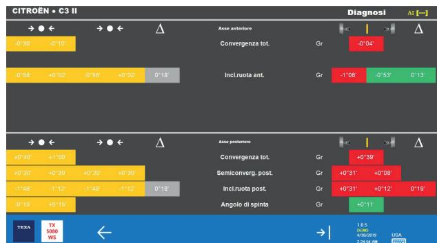
Изображение считываемых данных от четырёх датчиков CCD, сравниваемых с установленными производителем номинальных значений. Если значения подпадают под допуски, то можно продолжить расположение RCCS 2.
