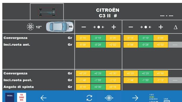
В фазе проверки угла установки колёс ПО позволяет установить диаметр колёс и показывает номинальные диапазоны конвергенции, полу-конвергенции и угла тяги.
