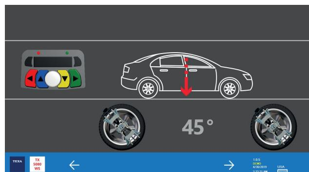
Расположить 4 датчика на крепежи и осуществить Run Out. На данный момент переместить назад ТС так, чтобы крепёж был под углом 45°. В последствии ТС перемещается вперёд, чтобы вернуться в вертикальное положение.
